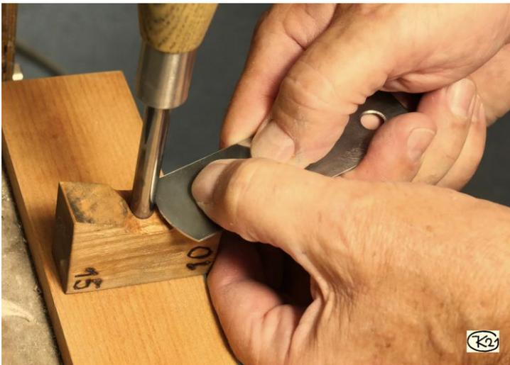
**Bild 22: Andrücken des Schneidgrates an eine kleine Ziehklinge mit nach außen gekrümmter Schneide.**
