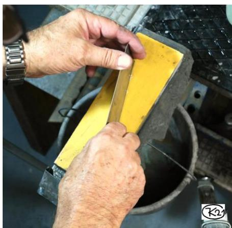
**Bild 19: Schleifen einer 90°- Standardziehklinge, freihändig**
