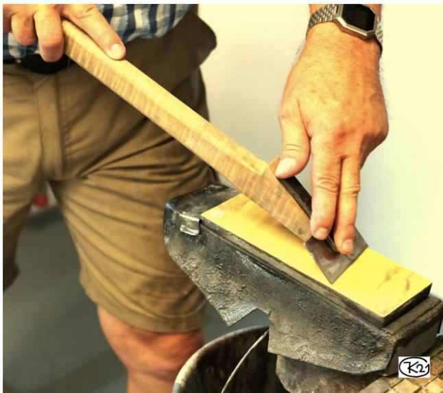
**Bild 23: Freihändiges Schleifen einer 45°- Ziehklinge mit einem Halter**
