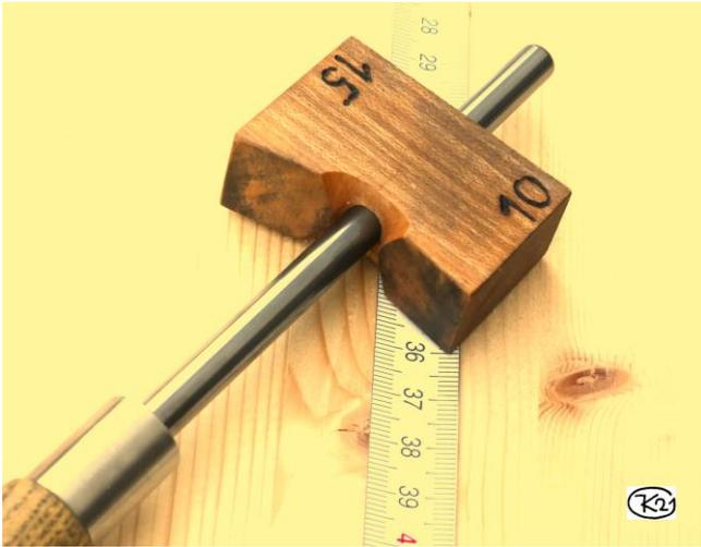
**Bild 27: Noch eine Führung** (10° und 15°, z.B. für kleine Sonderziehklingen)
