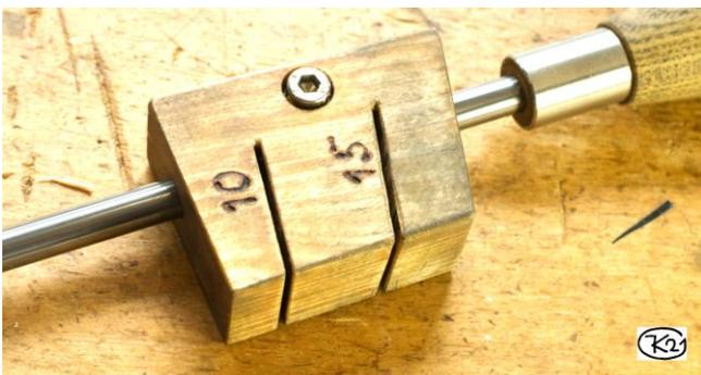
**Bild 26: Führung 10° / 15° mit Schlitzen**
