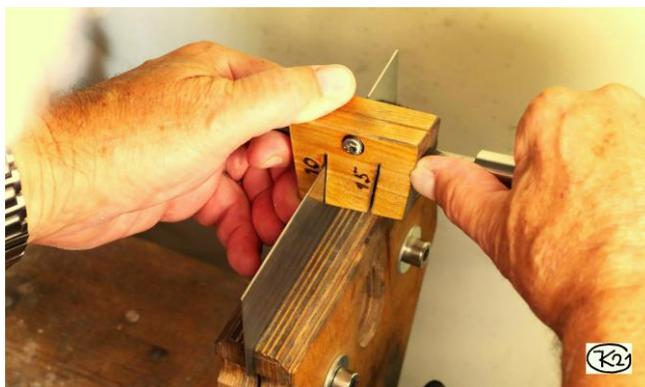
**Nach dem Andrücken des Schneidgrates ist die Ziehklinge fertig geschärft und einsetzbar.**
