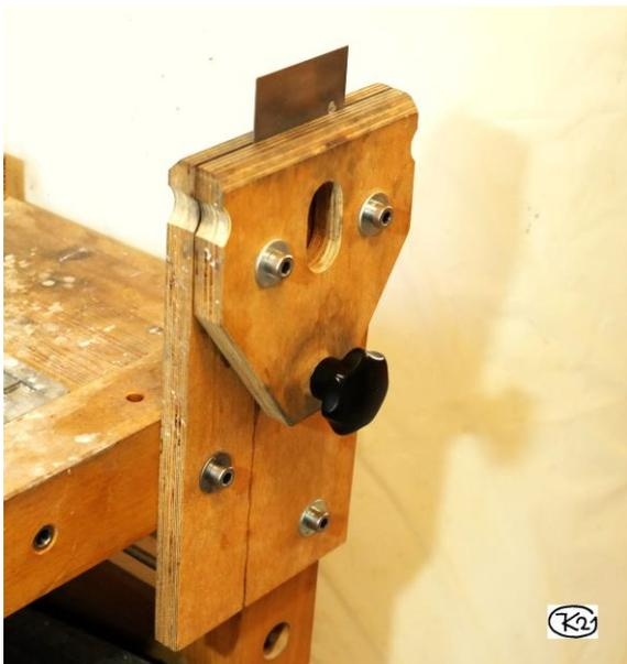
**Bild 30: Spannstock für Ziehklingen**
