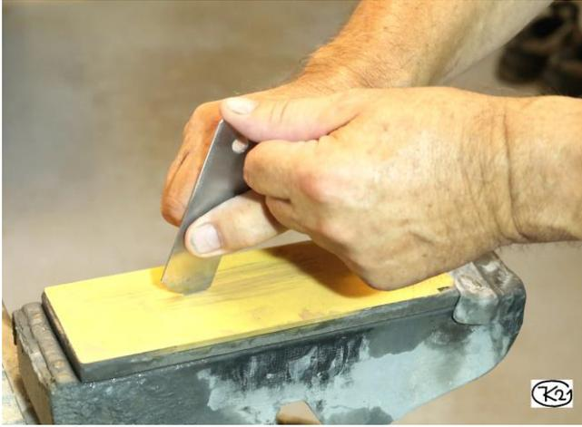
**Bild 21: Freihändiges Schleifen einer schmalen, nach außen gekrümmten Kantenfläche (Beispiel)**
