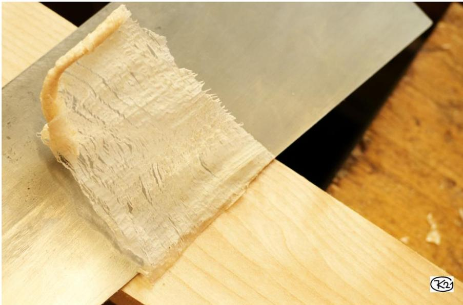
**Bild 17: Span einer aufwändiger geschärften  $90^\circ$ -Zieh Klinge**
